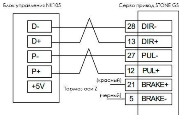
Рис. 72 Монтажная схема NK105 и серво привода STONEGS
